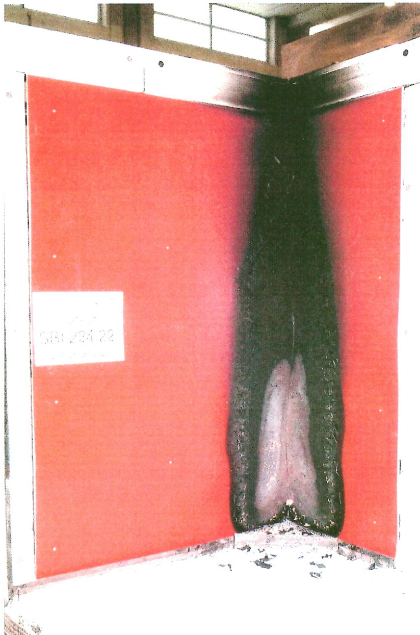
Aussehen des eingebauten Probekörpers D nach dem Versuch
