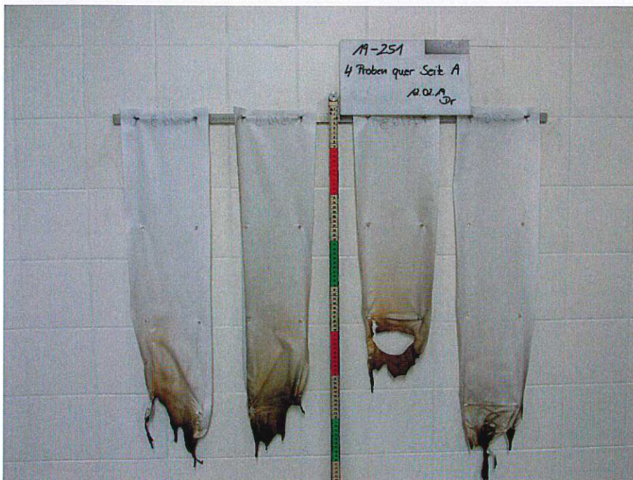
Bild 2: Aussehen der Proben nach dem Brandversuch
